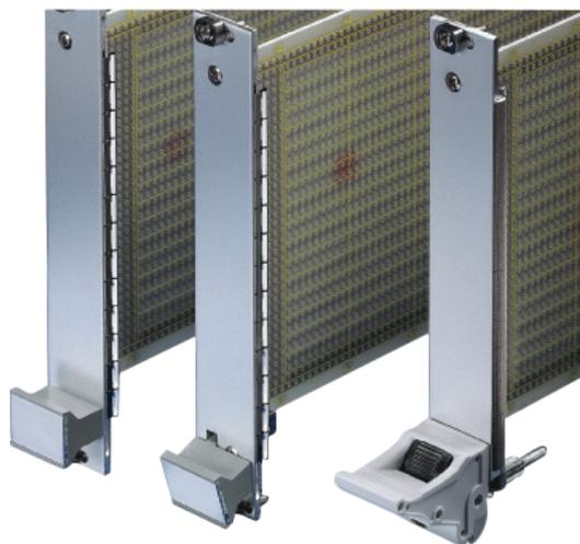
Illustration 6: Avec un module enfichable blindé muni d'un joint à ressort CEM
